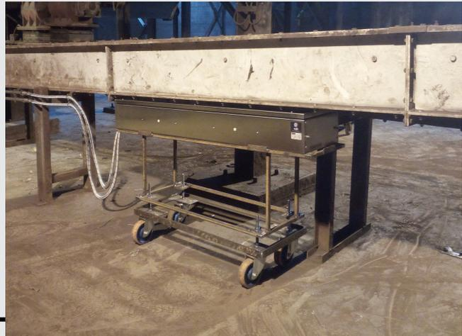
Applicazione specifica di GSU DYMO: monitoraggio di materiali trasportati su nastro trasportatore
