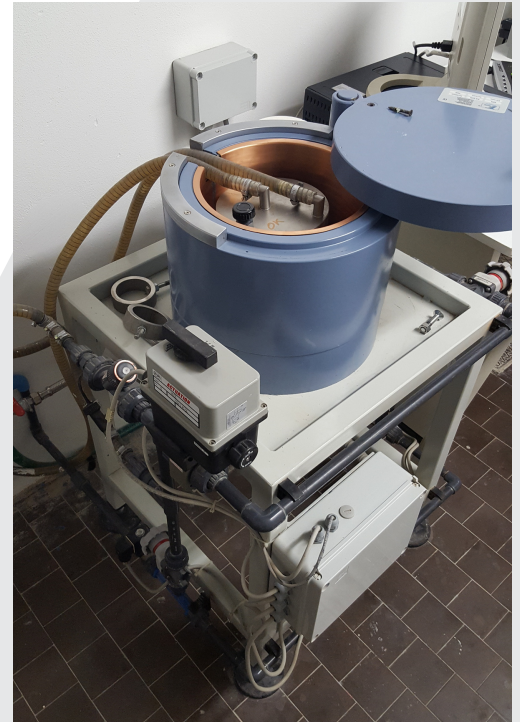
Camera di misura in geometria Marinelli all'interno del pozzetto in piombo
