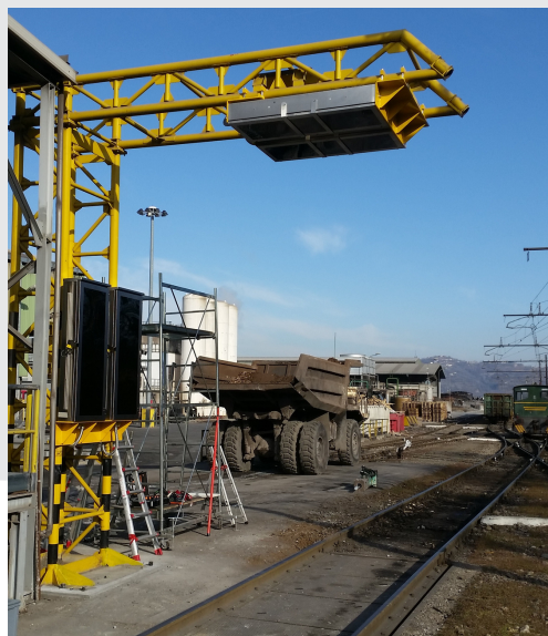
GALILEO 4UL per vagoni su pesa ferroviaria
