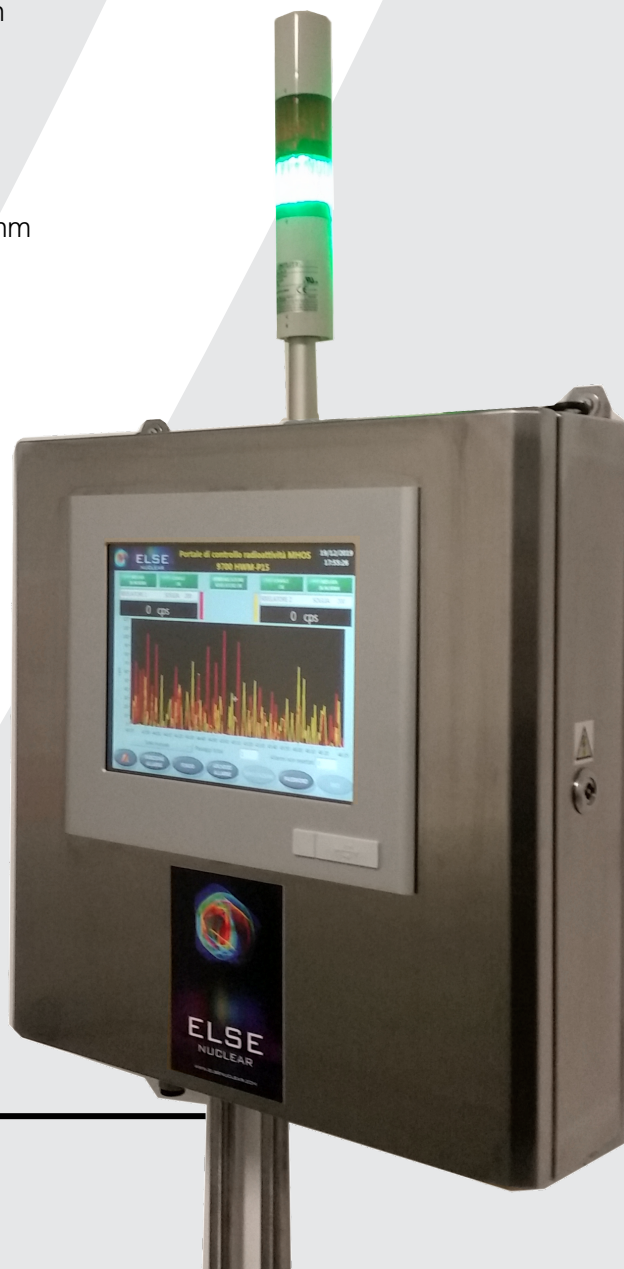
Console di controllo a panel PC di MHOS P15
