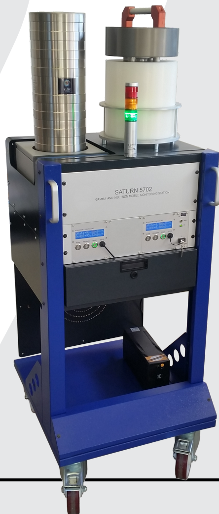
Stazione mobile di monitoraggio SATURN 5702
